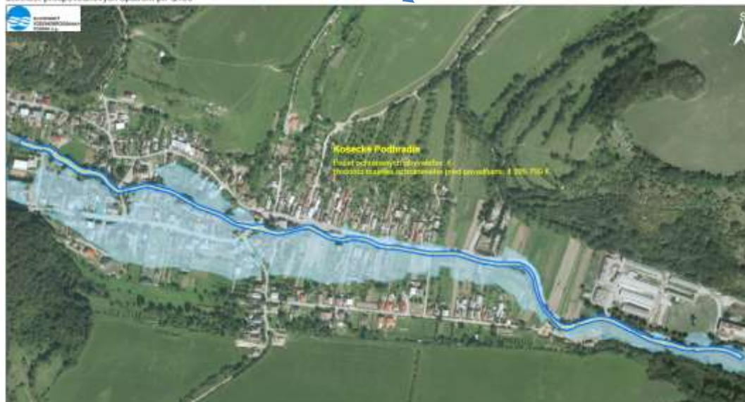
Košecké Podhradie - úprava toku Podhradský potok účinnosť protipovodňových opatrení pri Q100
